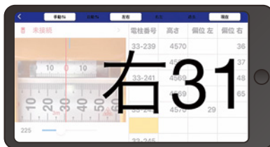
架線調整モード (偏位の拡大表示) 偏位の現在値の読み上げに便利!!
