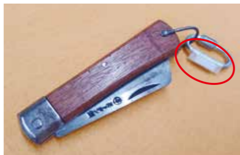
【電工ナイフ】熱収縮チューブ+金属リングにて固定
