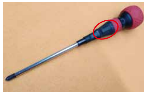
【ドライバー】熱収縮チューブにて固定
